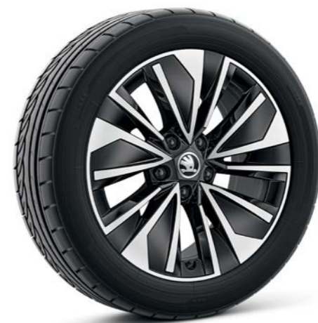
17" kola z lehké slitiny Alrakis černá leštěná disk: 7,5J × 17" ET41 pneu: 215/55 R17
