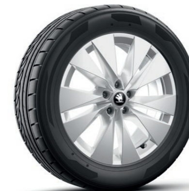
19" kola z lehké slitiny Proteus Vpředu: 8J × 19" ET45 | 235/55 R19 Vzadu: 8J × 19" ET45 | 235/55 R19 8J × 19" ET45 | 255/50 R19 pro verzi 85
