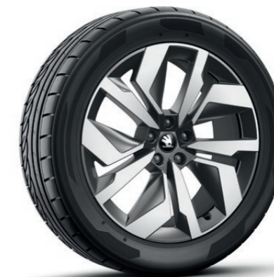
20" kola z lehké slitiny Vega, černá leštěná Vpředu: 8J × 20" ET45 | 235/50 R20 Vzadu: 8J × 20" ET45 | 235/50 R20 9J × 20" ET42 | 255/45 R20 pro verzi 85
